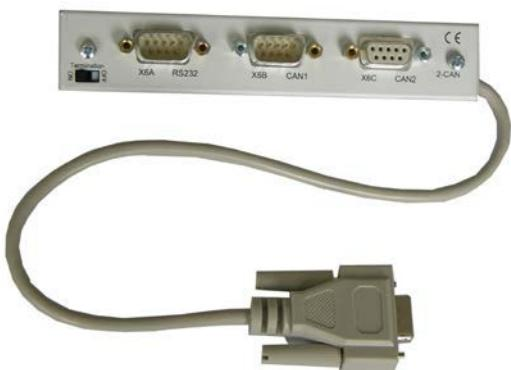
Штекерный разъем X6 сервоусилителя SERVOSTAR предназначен для сигналов интерфейса RS232 и интерфейса CAN. Поэтому расположение выводов интерфейсов не является стандартным и, если вы собираетесь использовать оба интерфейса одновременно, для них требуется специальный кабель.
