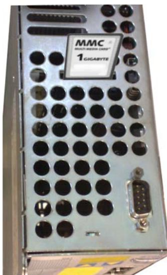
Сверху в сервоусилителе находится устройство для считывания карт MMC. При помощи кнопок управления или ПО для ввода в эксплуатацию на карте памяти можно сохранить ПО и полный набор параметров и снова загрузить их в сервоусилитель.
